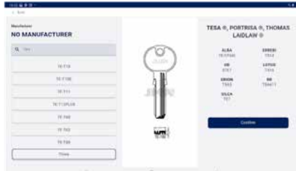
1.- Leerer Bildschirm der Modelleingabe 2.- Bildschirm der Modelleingabe mit Vorschlägen und das ausgewählte Modell TE-T60 (Mit Abbildung und Informationen zu Herstellern, die diesen Schlüssel verwenden, und äquivalente Referenzen anderer Hersteller).
