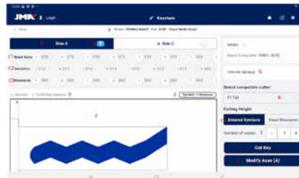
Pantalla de ficha de llave después de una lectura de una llave
