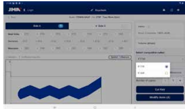
Selektor frezu umożliwiający wybór domyślnie przypisanego frezu lub frezu interpolacyjnego zgodnie ze wskazaniem karty klucza.
