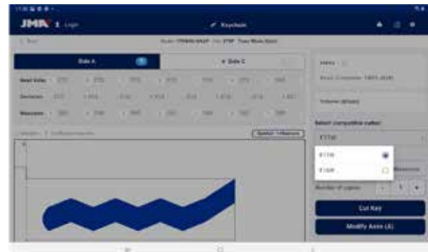
Seletor de fresa entre a fresa atribuída por defeito e a fresa de interpolação definida na ficha de chave.
