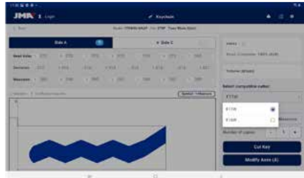
Selector de fresa entre la asignada por defecto y la de interpolación definidas para la ficha de llave.
