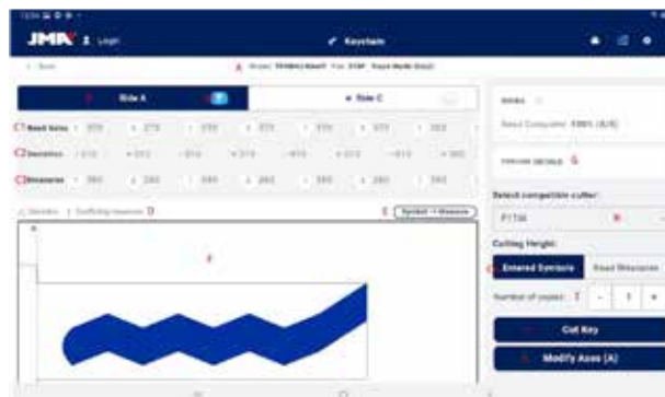
Tastatur und Schlüsseldatenblatt beim Eingabevorgang der Zahnung
